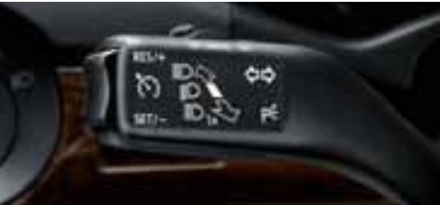
Geschwindigkeitsregelanlage für Fahrzeuge mit Bordcomputer (3T0 035 623), für Fahrzeuge ohne Bordcomputer (3T0 035 623A)
