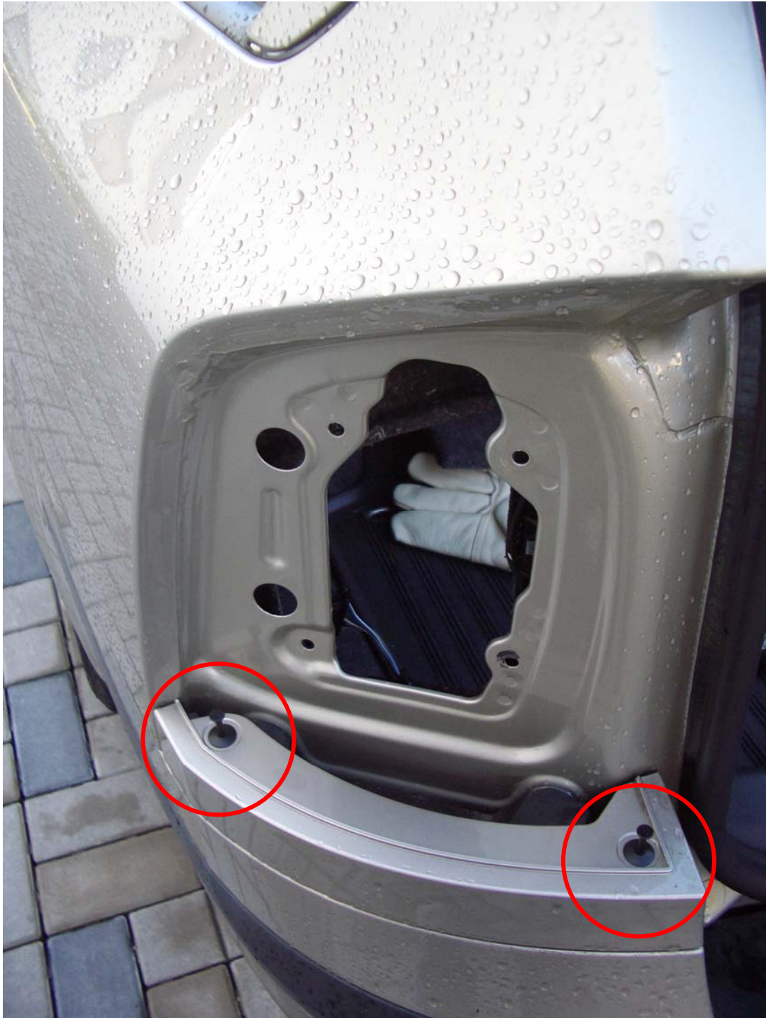
Abbildung 3 Spreizdorne unterhalb der Heckleuchten (Heckleuchten demontiert)
