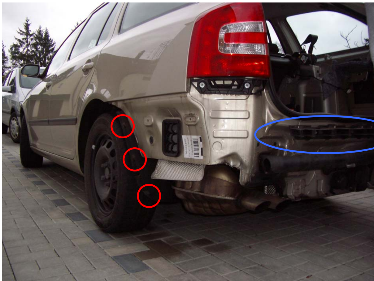
Abbildung 2 Verschraubung im Radkasten (nur rote Markierungen!)
